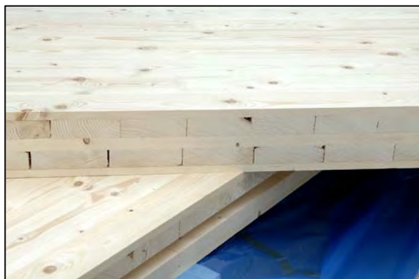
Bilde 27. Typisk massivtreelement. Foto: Moelven massivtre AS
