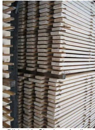
Bilde 12. Skurlast, ferdig tørket. Foto: Kjersti Folvik
