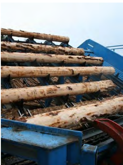
Bilde 7. Barking av tømmer Foto: SINTEF Byggforsk
